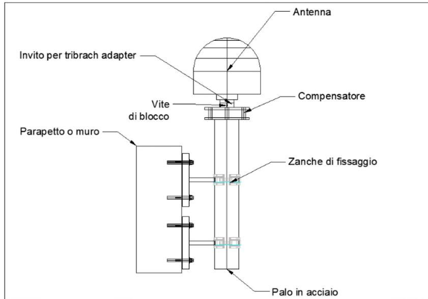
**Figura 1 Disegno installazione antenna**
