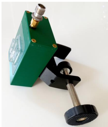
Figura 7 – Front-End con staffa di fissaggio a palina topografica
