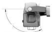
Figura 1 - Rotazione del tubo radiogeno intorno al proprio asse
