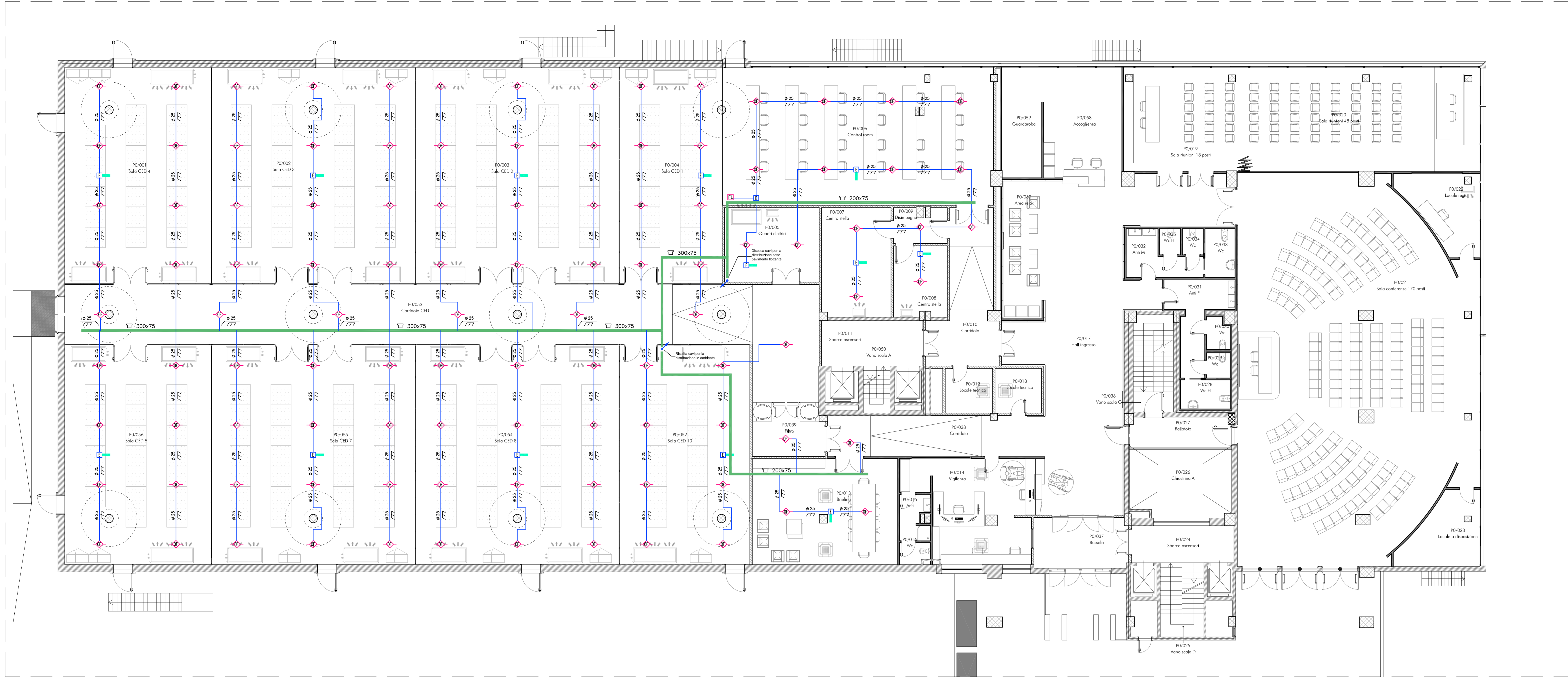
Pianta piano terra - Distribuzione sotto pavimento Impianto Rivelazione Incendi Scala 1:100
