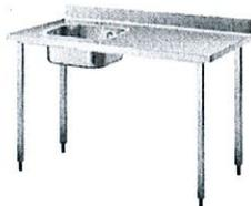
Tavolo in acciaio inox AISI 304 con piano di lavoro da 50 mm e spessore 10/10. Insonorizzato con piega salvamani sui bordi e sottopiano rinforzato in pannello idrofugo. Gambe quadre in acciaio inox AISI 304 (40x40 mm) con piedini regolabili in altezza. Alzatina paraspruzzi posteriore con raggiatura 10 mm, altezza 100 mm e spessore 13 mm. Una vasca da 400x400x200 mm posizionata a sinistra e dotata di tubo troppopieno e piletta di scarico.
