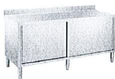
Tavolo in acciaio inox AISI 304 con piano di lavoro da 50 mm e spessore 8/10. Struttura interna saldata. Porte scorrevoli fonoassorbenti. Ripiano intermedio regolabile e piedini ad altezza regolabile. Alzatina paraspruzzi posteriore con raggiatura 10 mm, altezza 100 mm e spessore 13 mm.
