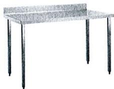
Tavolo in acciaio inox AISI 304 con piano di lavoro da 50 mm e spessore 10/10. Insonorizzato con piega salvamani sui bordi e sottopiano rinforzato in pannello idrofugo. Gambe quadre in acciaio inox AISI 304 (40x40 mm) con piedini regolabili in altezza. Alzatina paraspruzzi posteriore con raggiatura 10 mm, altezza 100 mm e spessore 13 mm.
