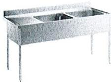
Lavatoio in acciaio inox AISI 304 con piano di lavoro da 50 mm e spessore 8/10. Insonorizzato con piega salvamani sui bordi e dotato di invaso perimetrale ed angoli saldati. Gambe quadre in acciaio inox AISI 304 (40x40 mm) con piedini regolabili in altezza. Alzatina paraspruzzi posteriore con raggiatura 10 mm, altezza 100 mm e spessore 13 mm. Due vasche da 500x500xh250 mm dotate di tubo troppopieno e piletta di scarico da 2". Gocciolatoio stampato posizionato sulla parte destra.
