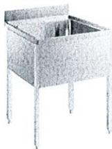
Lavatoio in acciaio inox AISI 304 con piano di lavoro da 50 mm e spessore 8/10. Insonorizzato con piega salvamani sui bordi e dotato di invaso perimetrale ed angoli saldati. Gambe quadre in acciaio inox AISI 304 (40x40 mm) con piedini regolabili in altezza. Alzatina paraspruzzi posteriore con raggiatura 10 mm, altezza 100 mm e spessore 13 mm. Una vasca da 500x500xh250 mm dotata di tubo troppopieno e piletta di scarico da 2".
